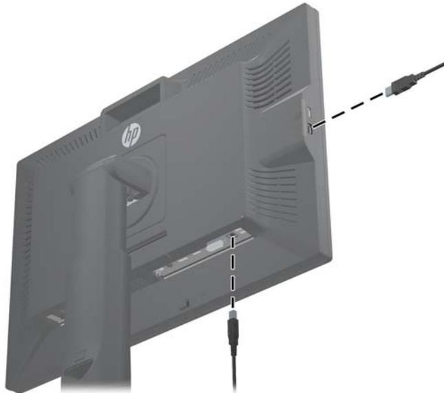
5. Conecte un extremo del cable de alimentación en el conector de alimentación en la parte trasera del monitor y el otro extremo a una toma de corriente.
