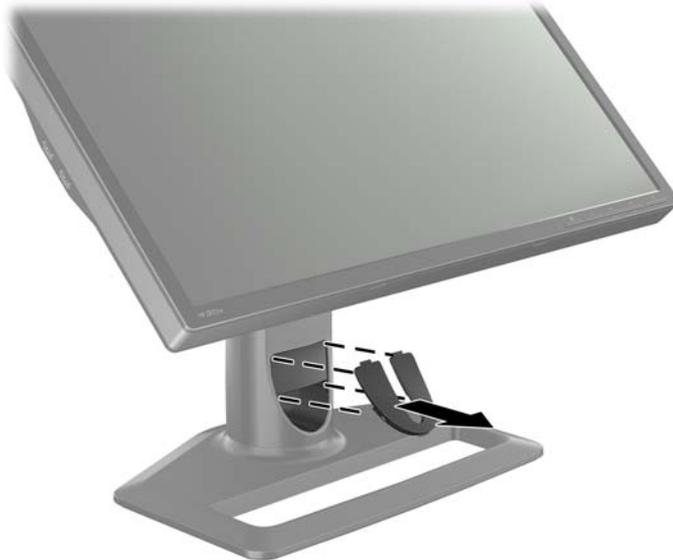
2. Antes de conectar los cables, rutéelos a través del orificio de ruteo de cables en la columna (1), y recoloca la cubierta de ruteo de cables (2).
