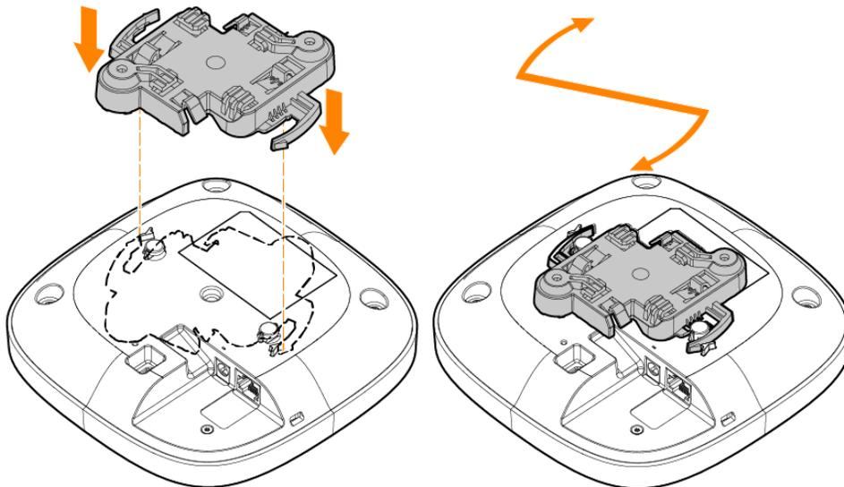
4. Sujete el punto de acceso junto al riel del techo con las lengüetas de montaje del soporte de montaje en un ángulo de aproximadamente 30 grados con respecto al riel del techo. Asegúrese de que el cable sobrante esté por encima de la placa del techo.
