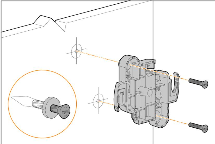
5. Alinee el punto de acceso con el soporte de montaje, colocándolo de manera tal que las lengüetas de montaje queden a un ángulo aproximado de 30 grados con respecto al soporte de montaje.
